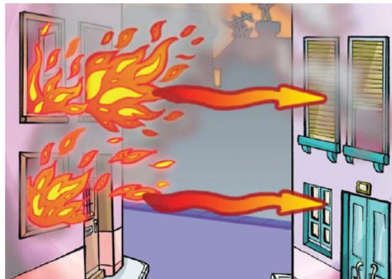
Fig. Propagação do Calor por Irradiação
