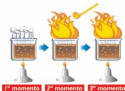
Fig. Temperatura de Auto Ignição
